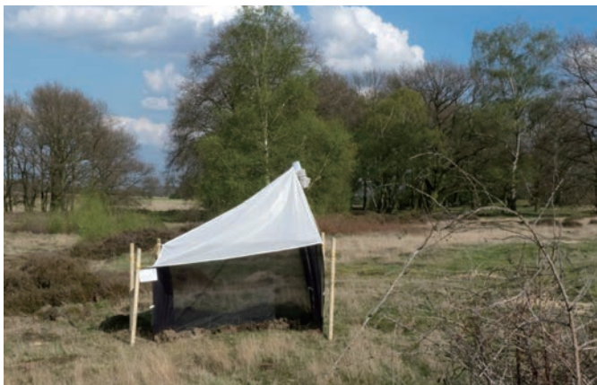
図-1 調査区に設置された飛翔昆虫捕獲用のマレーズトラップ。テントにぶつかった虫は上へとよじ登り、最上部にしかけられた採集瓶の中に落ちる仕組みになっている。(Hallmann ほか 2017 より)
