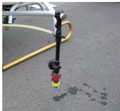
図-2 無人ヘリ用ノズルTP3349 機体の側面の左右に1本ずつ装着されている。 撮影日：2011年7月22日、撮影場所：宮城県仙台市
