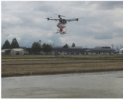
図-9 ドローンを用いたべんモリ直播の様子 佐賀県農業試験研究センターにおいて (株)井関農機が播種
