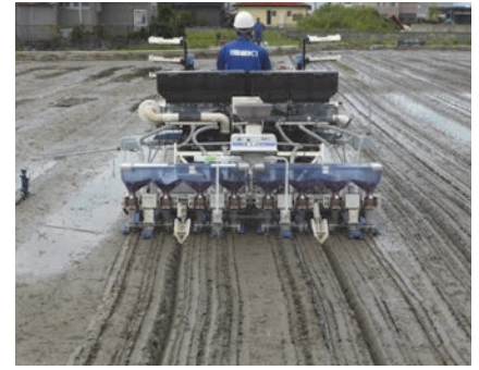
図-4 覆土板を用いた土中播種機による播種
