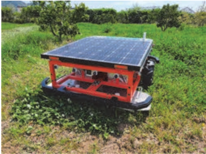
図-2 踏圧ロボット‘グラプレス’
