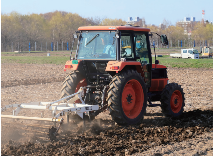
図-1 チゼルプラウによる荒耕起
