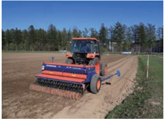
図-4 グレーンドリルによる播種(砕土と播種を別行程で行う場合)
