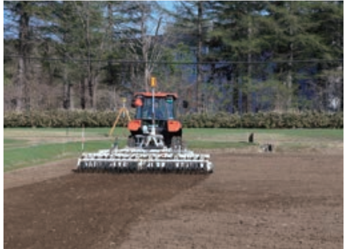
図-2 レーザー均平機による均平作業
