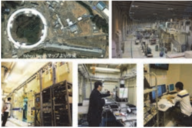
図-3 SPring-8 でのX線 CT 計測 全景（上段左図）、リング内に配置された測定室（上段右図、著者が2014年に撮影）、測定室（下段左図）、測定試料の設置（下段中央）と測定の制御（下段右図）。
