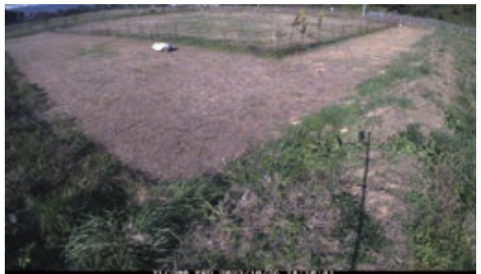
図-6 メッシュ型の防獣柵周囲を自律型の草刈ロボットが走行する様子 (上図：柵に衝突する前，下図：柵に衝突した後に方向を変えて進行（上図の5秒後））
