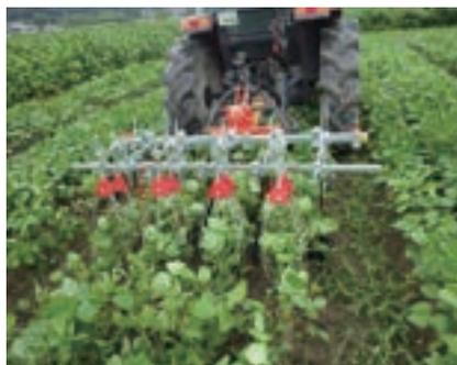
図-4 トラクタに除草カルチを装着し走行している様子
