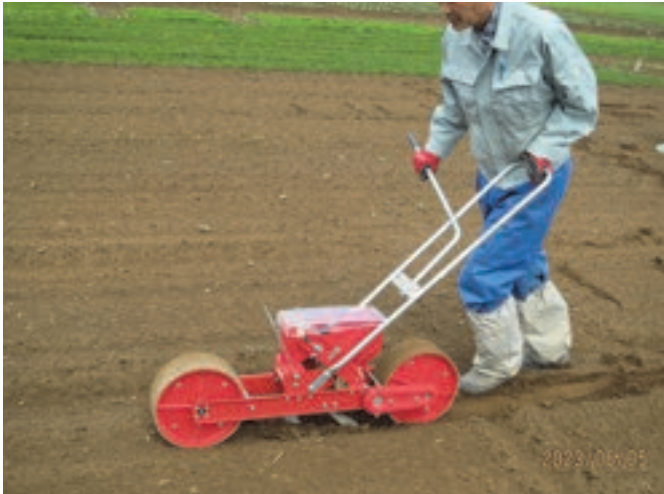
図-8 手押し式播種機による作業
