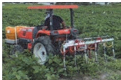
図-1 後方吊り下げ型畦間・株間散布機 (狭条栽培対応)
