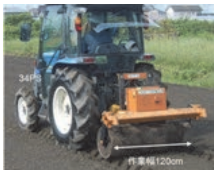
図-2 振動鎮圧作業【型式：SV2-T(川辺農研産業(株))】
