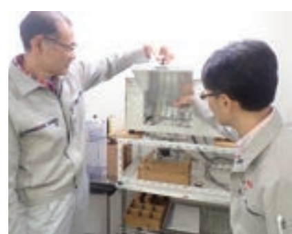
図-10 水中光分解動態試験装置
