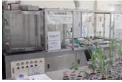
図-4 自動薬液散布装置
