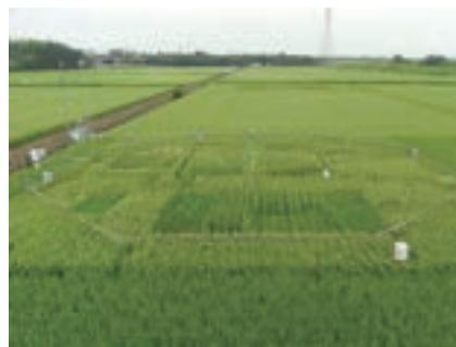
図-1 つくばみらい市で実施された FACE (開放系大気 CO<sub>2</sub> 増加) 実験の様子。差し渡し 17m の八角形状区画の中央部に CO<sub>2</sub> 濃度センサーと風向・風速計を設置し、区画内の CO<sub>2</sub> 濃度が対照区に対して 200ppm 高くなるように、周辺部に設置した放出チューブから風向きに応じて CO<sub>2</sub> ガスを放出する。
