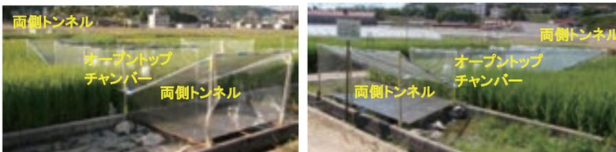
図-6 風向が一定しない地域に適した温風導入型オープントップチャンバー
