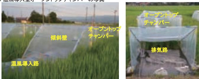
図-3 風向が一定な地域に適した温風導入型オープントップチャンバー
