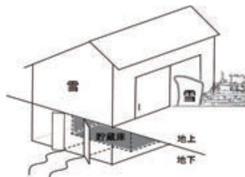
図 -1 実験に使用した雪室の模式図（新潟県上越市）
