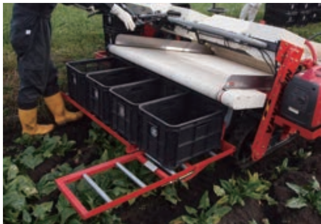
図-5 歩行型ハウレンソウ収穫機の小型コンテナ横流れユニット
