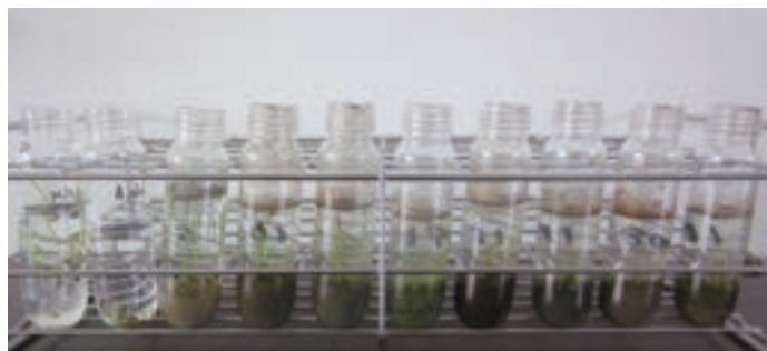
図-3 ヒメタイヌビエに対する生育抑制効果の比較試験結果 左から、塩化カルシウム溶液、除草剤試験溶液、土壌吸着係数大→小の土壌
