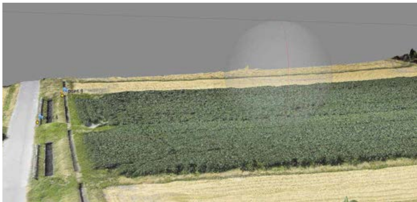
図-7 ドローンの空撮画像から作成した DSM (digital surface model) 画像 写真は大豆圃場を直下視した画像に三次元情報を与えて自動合成したもの(渡邊ら 2015)。
