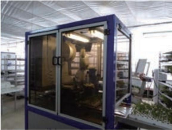
図-9 オランダ ISO 社の接ぎ木ロボット (Graft 1200)
