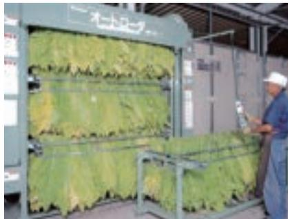
図-11 黄色種機械乾燥室（乾燥前）
