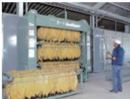
図-12 黄色種機械乾燥室（乾燥後）
