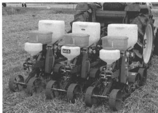
図-8 本技術開発の試験に使用した不耕起播種機
