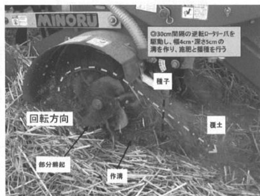
図-8 本技術開発の試験に使用した不耕起播種機
