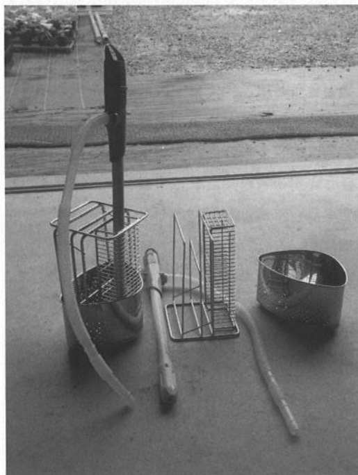
写真-8 試験区の水深調節器
