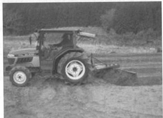
図-6 リアグレーダで表層を剥離
