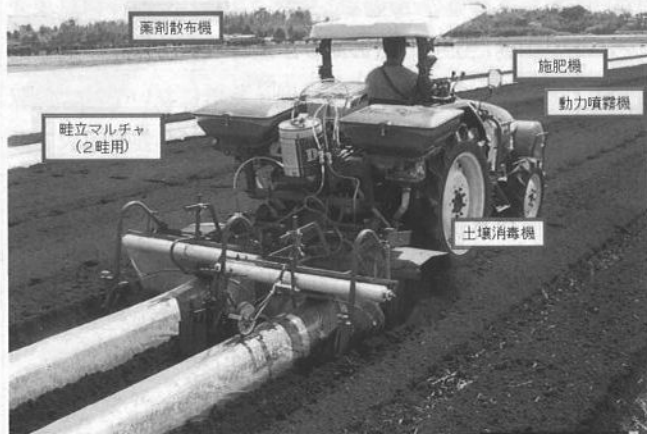
図-6 畦立同時施肥・施薬・除草剤散布機の概要
