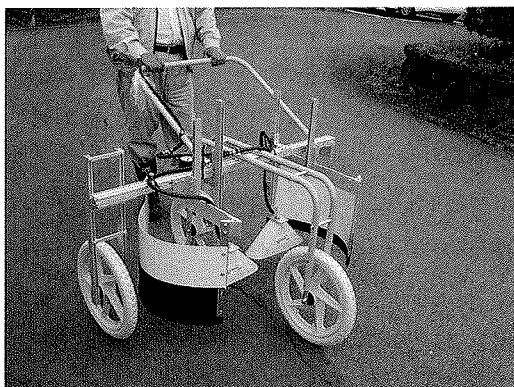
図－２ 植調が開発した歩行型畦間散布機
