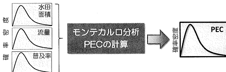
図-3 モンテカルロシミュレーションによるPECの分布計算の概念図
