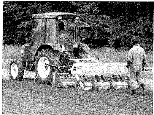
図-2 平畝ムギ類・ダイズ同時播種機 ダイズの条間にムギ類が条播される。
