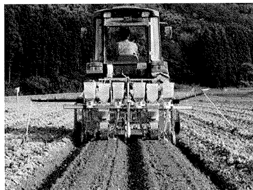
図-3 畝立てムギ類・ダイズ同時播種機 ムギ類とダイズの両方が畝の上に条播される。
