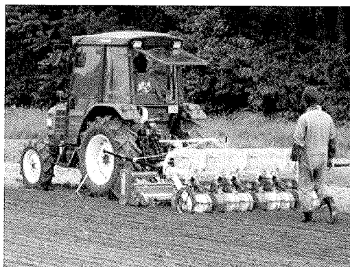
図-2 平畝ムギ類・ダイズ同時播種機 ダイズの条間にムギ類が条播される。
