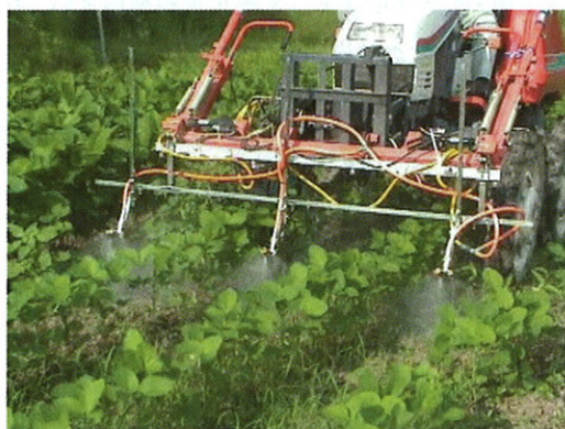
写真-5 乗用管理機による畦間除草剤散布の様子(2005.7.14, 愛知農総試内ほ場)
