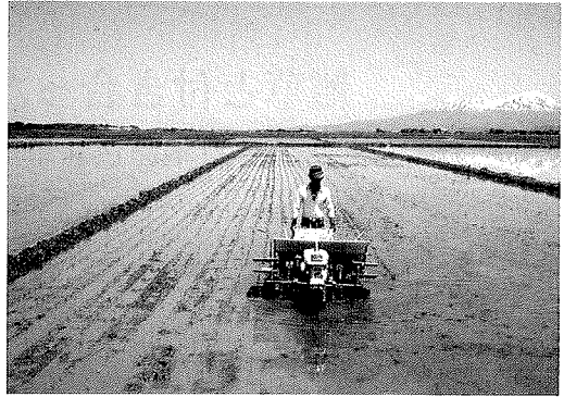
▲稲に安全な除草剤が開発され、田植機による稚苗移植早期栽培ができるようになった。
