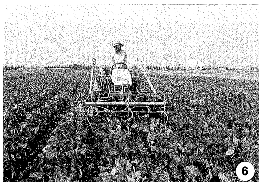
図-6 吊り下げノズルを用いた乗用管理機によるダイズ畑の畦間除草
