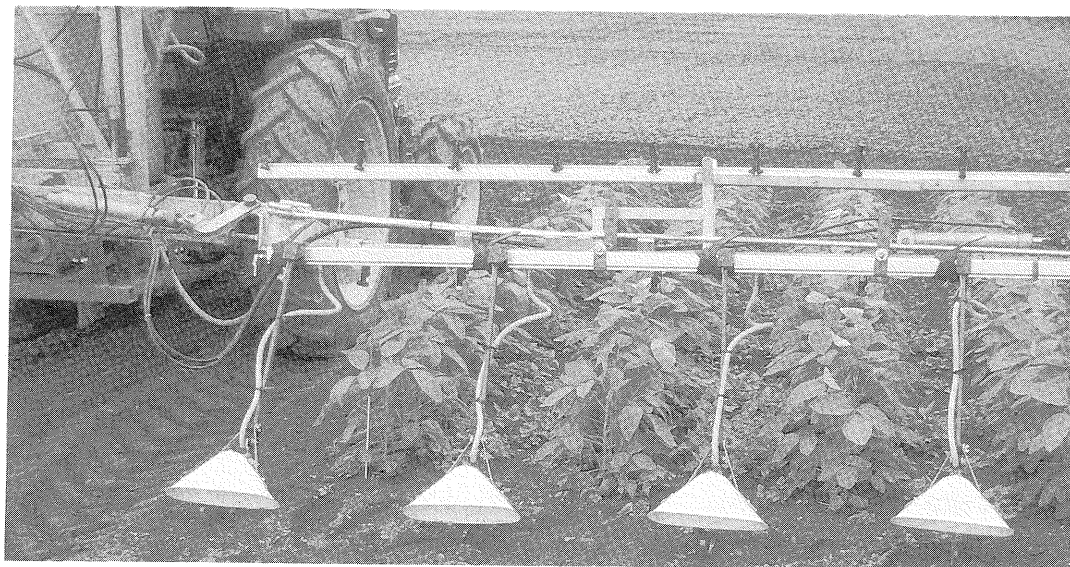
写真-5 万能散布バー(北海道糖業株)を用いた畦間散布試験
