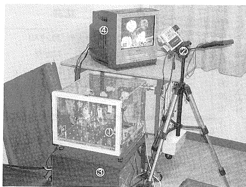
図-4 エチレン感受性検定用ビデオシステム ①エチレン処理用チャンバー、②ビデオカメラ、③ハードディスクビデオレコーダー、④TVモニター
