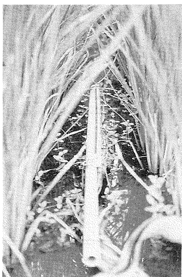
図-1 試作した光センサーアレー (上段), およびこれを水田の畝間田面に挿入しているところ (下段)。
