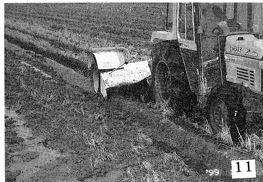
写真-11 あぜ塗り機によるあぜ塗り(福井市) 田の天水田において、このような秋のあぜ塗り 作業の光景を初めて見た時、厳しい自然環境の
