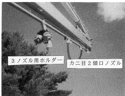
図-7 2～3種類のノズル装着用ホルダー
