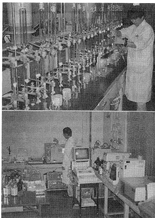
写真-2. 土壌サンプルのクリーン・アップ(上)とガスクロマトグラフィーによる分析
