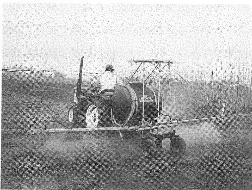
写真2. ブームスプレーヤーによる機械収穫桑園の除草剤秋冬期処理作業
