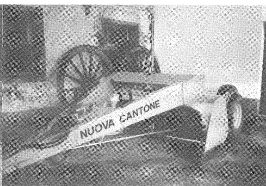
写真4. 整地機(レーザービームをボールの上にのせて調整、均平化をはかる)
