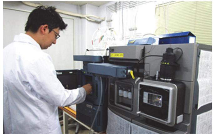
図-7 分析操作の様子（LC-MS/MSでの分析）
