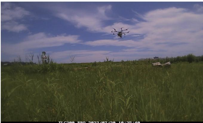
図-7 ドローンを用いた農業散布試験の様子
