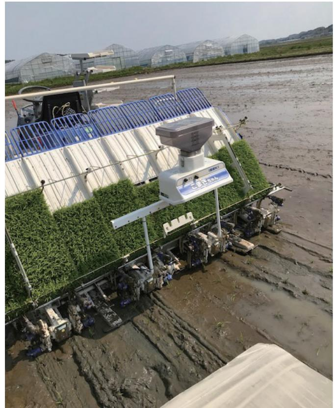
図-1 実機による田植同時散布
