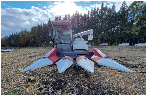
図-11 コーンヘッド装備の汎用型コンバイン (左：ヘッドの回転部でトウモロコシ茎葉を削ぎ落とす際に雑草の「つる」が絡みやすい 右：絡み合うことで切断に対し強靱なガガイモのつる)
