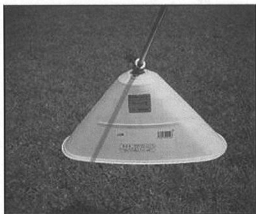
図-3 飛散防止カバー付き少量散布ノズル(左)とブラッシングエース(右)
