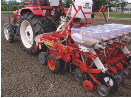
図-2 汎用不耕起播種機 (NSV-600) とそれを牽引するトラクター
