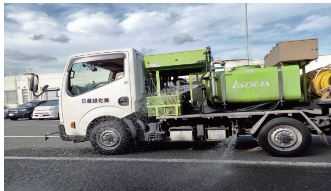
図-2 薬剤散布作業車による路肩散布デモ
