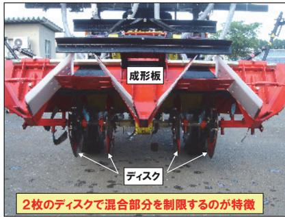
図-2 うね内部分施用法による部分施用部
