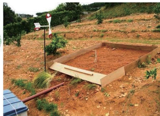
図-2 傾斜ライシメーターの概略（左）と傾斜 15°園地での設置状況（右）
