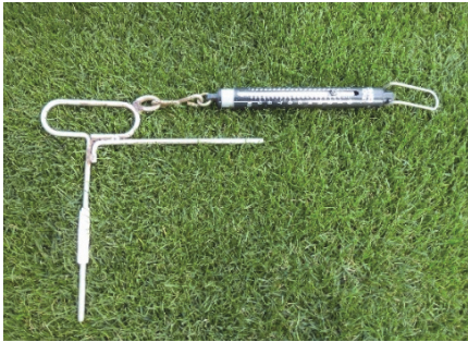
写真-9 地強度計 (右は計測中の強度計)
