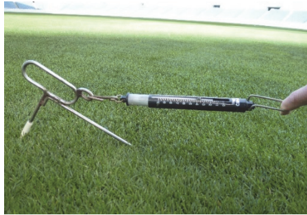
写真-9 地強度計 (右は計測中の強度計)
